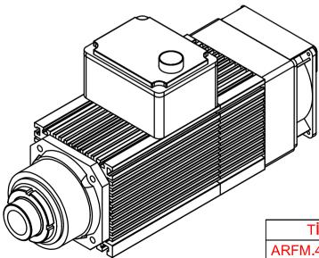
ΤİΡ KW HP **RPM** Amper Hz Voltaj Kg. ARFM.4T-S2 3 12.000 10,4 / 6 200 | 220 / 380 | 20,5 ARFM.4T-S3 5,5 18.000 14 / 8,2 300 220 / 380 20,5
